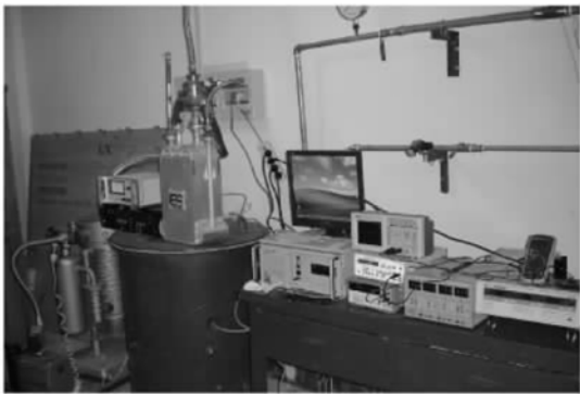
图 1 逆布雷顿空气制冷机试验台
